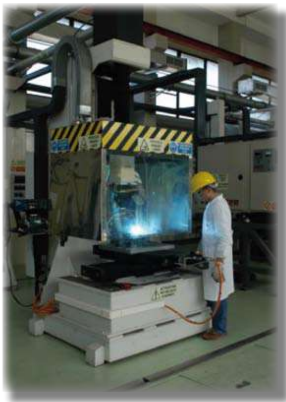
Stazione laser, sistema di movimentazione a 3 gradi di libertà X,Y,Z ad ottica fissa
