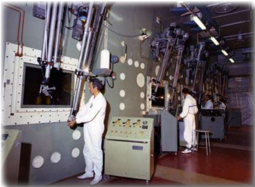
Operatori cella tiepida - impianto Itrec
