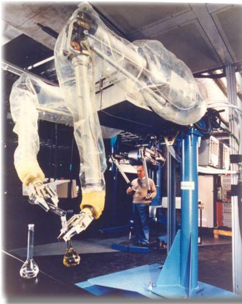
Teleoperatore MASCOT-4 in fase di operazione
